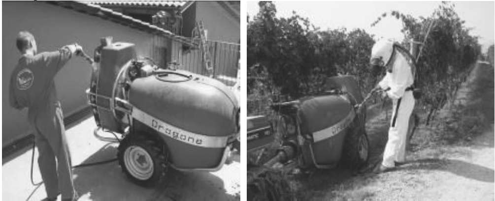
Figura 2. Lavaggio dell'irroratrice a fine trattamento su area attrezzata (sinistra) o direttamente in campo (destra)
