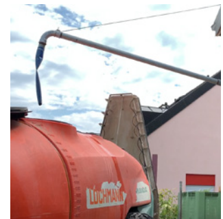
Le col de cygne évite le retour de bouillie dans le réseau.
