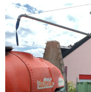
Un braccio mobile a collo di cigno evita il ritorno di poltiglia nelle condotte idriche.
