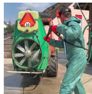
Un'idropulitrice permette di lavare adeguatamente trattori, irroratrici e macchinari.
