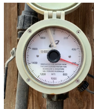
Un contatore volumetrico permette di dosare l'acqua in modo preciso.
