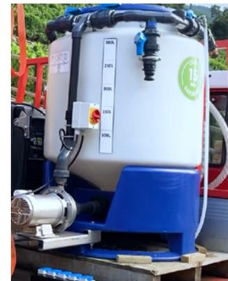
Une trémie de mélange (ici Mixbox) est idéale pour mélanger la bouillie pour les petits appareils de traitement (atomiseur, drone, etc.).
