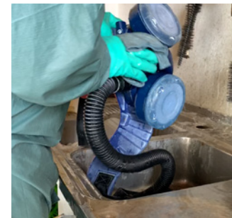
L'extérieur des EPI est toujours manipulé avec des gants...
