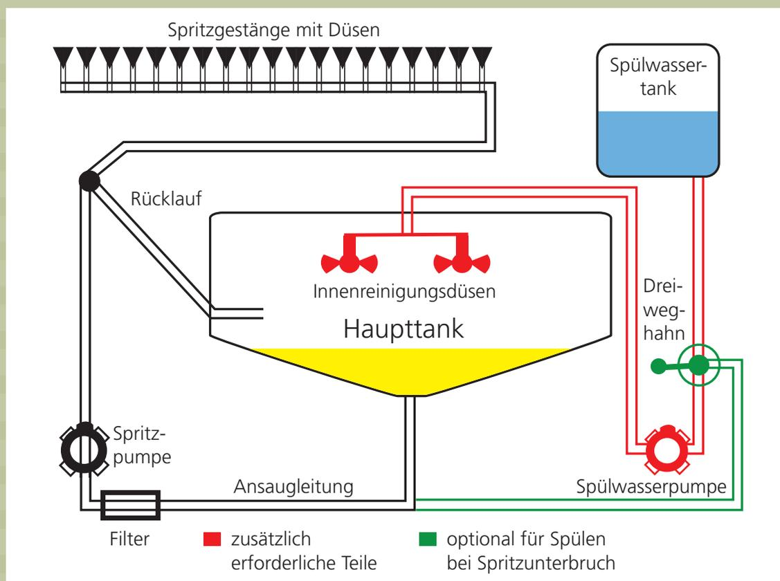
Die roten Teile sind für das beitragsberechtigte Innenreinigungssystem notwendig und werden finanziell unterstützt. Die grünen Teile werden nicht finanziell unterstützt. Falls gewünscht, dass das Spritzgestänge auch ohne Innenreinigung des Haupttanks gespült werden kann, müssen die grünen Teile installiert werden.
